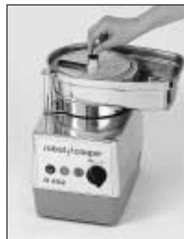
5) Установите крышку на чашу и поворачивайте ее вправо до тех пор, пока она не защелкнется, плотно закрыв чашу сверху.
