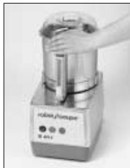
4) Установите крышку на чашу и поворачивайте ее вправо до полной блокировки.
